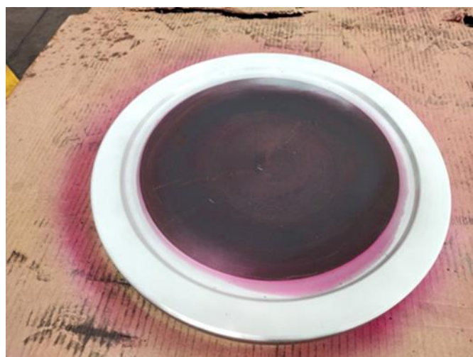
Контроль обработанной поверхности способом ПВК
