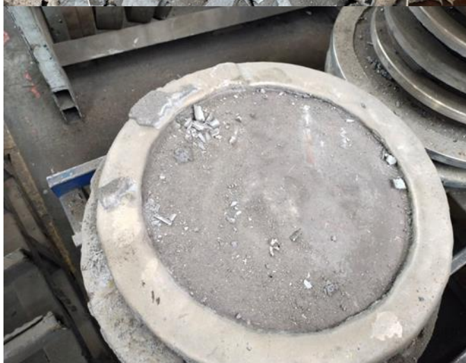
Шлаковая корка и наплавленная поверхность диска DN300 выполненная ранее используемыми сварочными материалами
