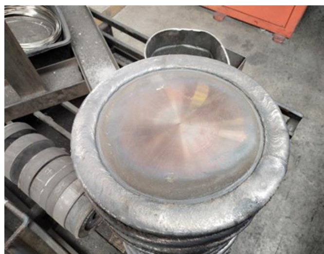
Шлаковая корка и наплавленная поверхность диска DN300 после наплавки новой комбинацией сварочных материалов
